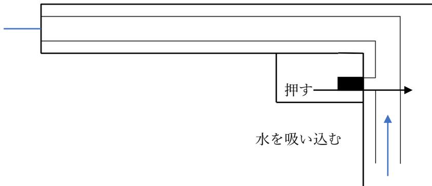
押し込むピストンはポンプの役割をしており、押し込む力の強さに比例して速度を大きくしている。この時の速度を $v_p$ 、流速を $v_o$ 、ピストン付近の圧力を $p_p$ 、水が流出するところ付近の圧力を $p_o$ 、基準面の高さをピストンの位置とし流出するところと基準面の高さの差を $h$ とすると、次のような式が成り立つ。
