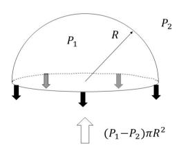
上の図のようなとき、表面張力によって液滴が縮もうとするので、 $P_1 > P_2$  である。また、液滴内外の圧力差による力と表面張力による力が釣り合うので以下の式が成り立つ。
