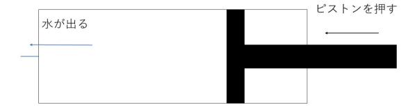
ピストンを押し出す速度を  $v_p$ , 求める流速を  $v_o$ , ピストン付近の圧力を  $P_p$ , 水が流出するところ付近の圧力を  $P_o$ , 基準面の高さ h を水が流出するところとすると, ベルヌーイの定理
