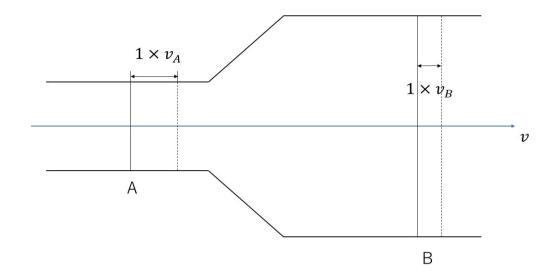
上の管路では流体が左から右に流れている。断面 A での断面積と速度を  $A_A$ ,  $v_A$ , 断面 B での断面積と速度を  $A_B$ ,  $v_B$  とする。1 秒あたりに流体は 1 秒 × 速度進むので,1 秒あたりに断面 A を通過する流体の体積は  $1 \cdot v_A \cdot A_A$ , B の方も同様に  $1 \cdot v_B \cdot A_B$  である。出てくる量は同じなので, $A_Av_A = A_Bv_B$  が成り立つ。したがって Av = const が成り立つ。両辺に密度をかけると流体力学における質量保存の法則のようなものになる。
