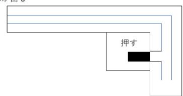
これの仕組みはトリガー (ピストン) を押して,管路の空気を押し出し真空となったとこに 水が吸い寄せられるというのを繰り返し,管路内を水で満たす.そして,ピストンで水を押し 出すという先ほどの竹水鉄砲タイプとあまり変わらない構造をしている.
